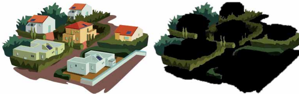
Figura 2: Rappresentazione visuale delle espressioni “area di insediamento” e “impermeabilizzazione del suolo”
